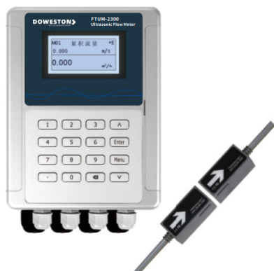
外夹式超声波流量计:FTUM-2300-TTO1 (适用温度: -40°C ~ +80°C) (适用管径: DN25-DN1200) (传感器材质: 工程塑料)
