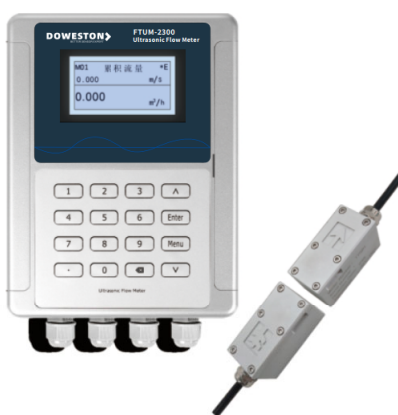
外夹式超声波流量计:FTUM-2300-TTO2H (适用温度: -40°C ~ +180°C) (适用管径: DN25-DN1200) (传感器材质: 铝合金)
