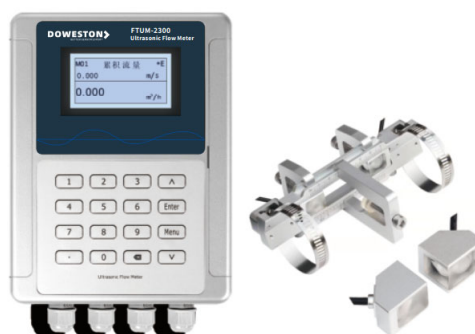
外夹式超声波流量计:FTUM-2300-TTO2H (适用温度: -40°C ~ +180°C) (适用管径: DN25-DN1200) (传感器材质: 铝合金)
