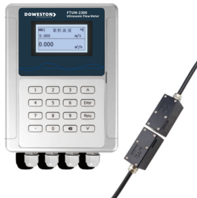
外夹式超声波流量计:FTUM-2300-TTO2 (适用温度: -40°C ~ +80°C) (适用管径: DN25-DN1200) (传感器材质: 铝合金)
