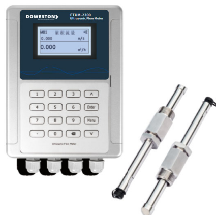
插入式超声波流量计:FTUM-2300-TTO5 (适用温度: -40°C ~ +130°C) (适用管径: DN100-DN1200) (传感器材质: 304不锈钢)
