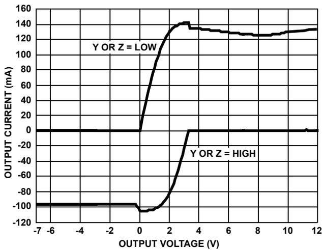
FIGURE 11. DRIVER OUTPUT CURRENT vs SHORT-CIRCUIT VOLTAGE
