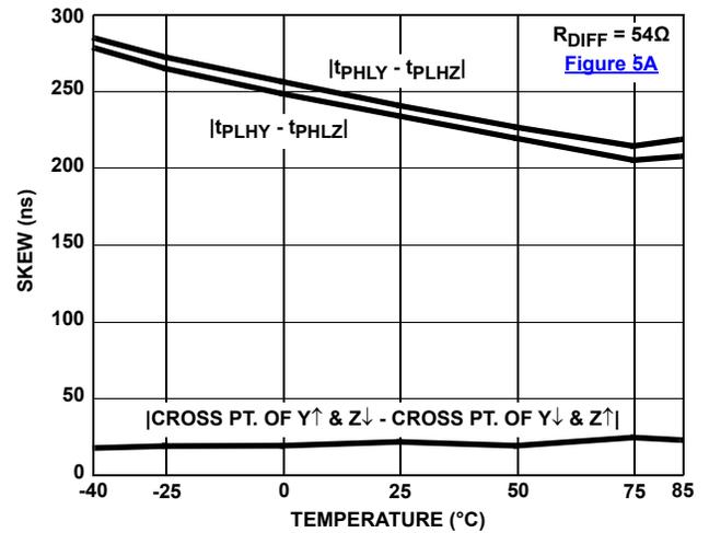
FIGURE 14. DRIVER SKEW vs TEMPERATURE (ISL83483, ISL83488)
