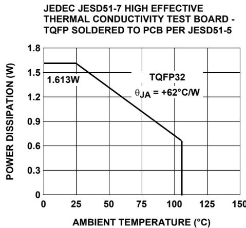
FIGURE 15. PACKAGE POWER DISSIPATION vs AMBIENT TEMPERATURE
