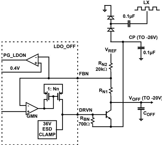
FIGURE 19. V<sub>OFF</sub> FUNCTIONAL BLOCK DIAGRAM
