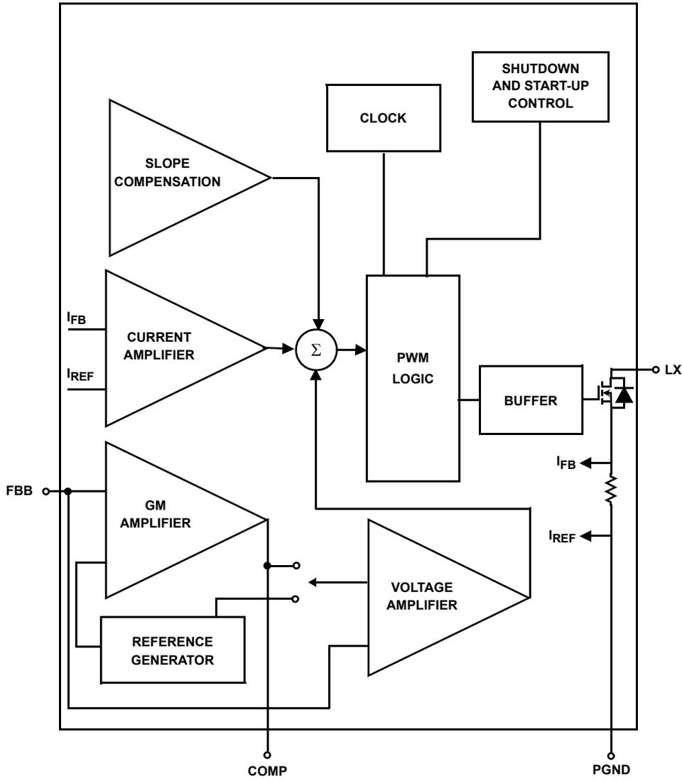
FIGURE 17. THE BLOCK DIAGRAM OF THE BOOST CONTROLLER
