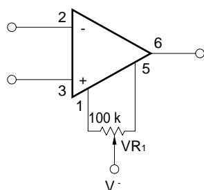
備考 OFFSET NULL端子は、オープンにするか、上図のように抵抗を通じて $V^-$ に接続して使用してください。 $V^-$ 以外への接続は、誤動作、特性劣化、破損の原因となります。
