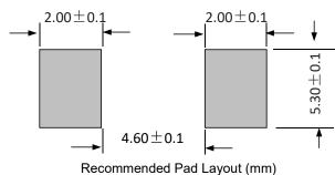
Recommended Pad Layout (mm) 建议焊盘布局(mm)
