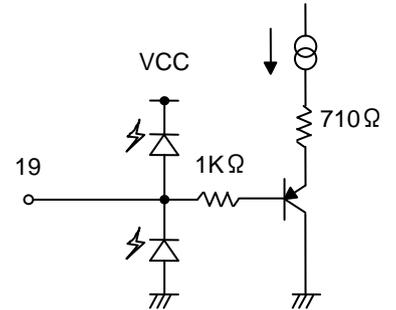
(10) Output pin (A1 : 24 pin, A2 : 22 pin, A3 : 20 pin)
