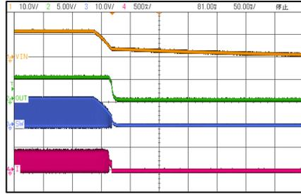
$V_{IN}=12V$   $V_{OUT}=5V$   $LOAD=20\Omega$
