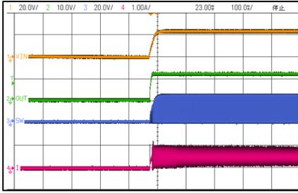
$V_{IN}=24V$   $V_{OUT}=12V$   $LOAD=20\Omega$
