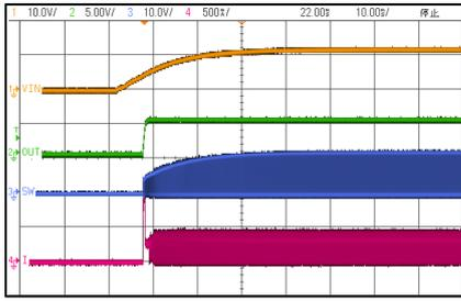
$V_{IN}=12V$   $V_{OUT}=5V$   $LOAD=20\Omega$
