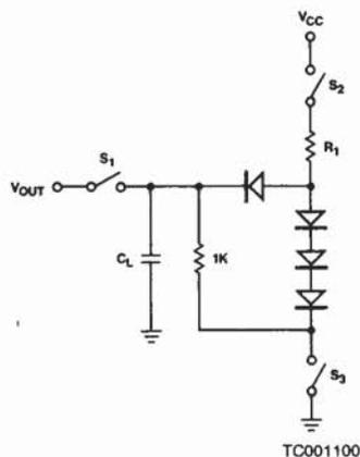
$$R_1 = \frac{5.0 - V_{BE} - V_{OL}}{\frac{I_{OL} + V_{OL}}{1K}}$$
