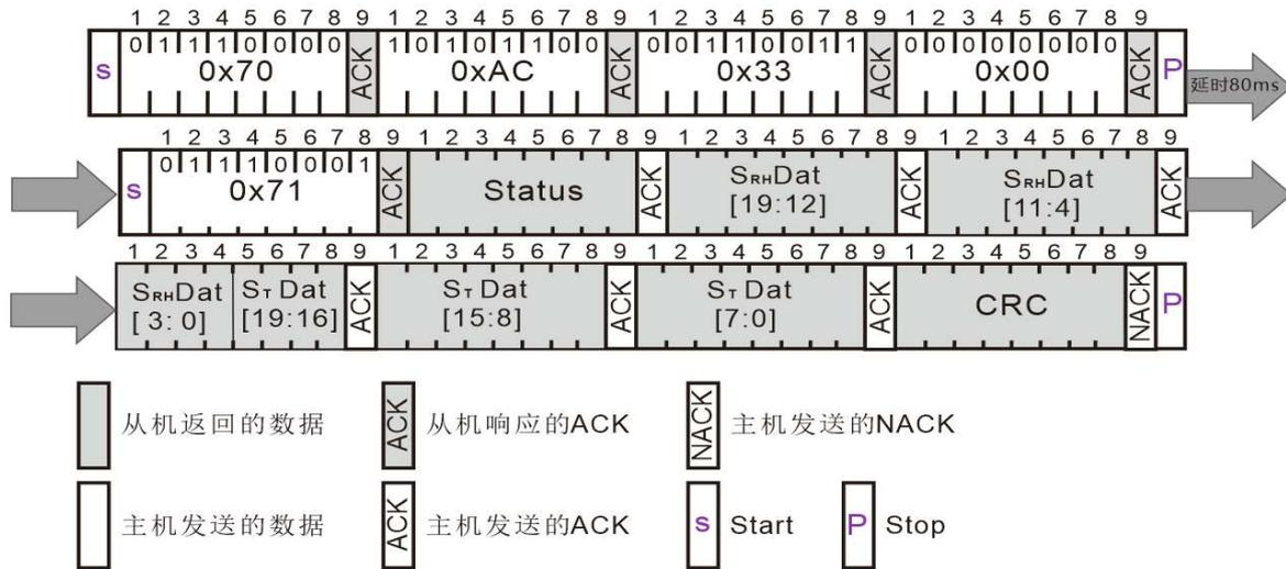
0x70 0xAC 0x33 0x00为向传感器发送写测量命令字节段；
