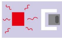
图13. 传感器与内部热源隔离可将内部热量对传感器测量的影响降至最低。
