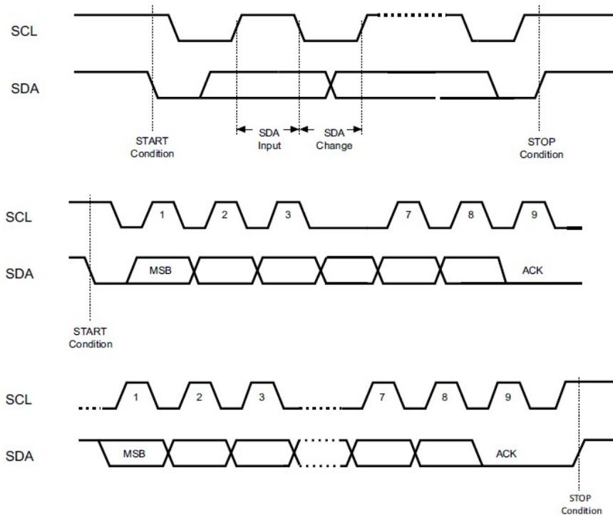
图17.I<sup>2</sup>C总线时序图
