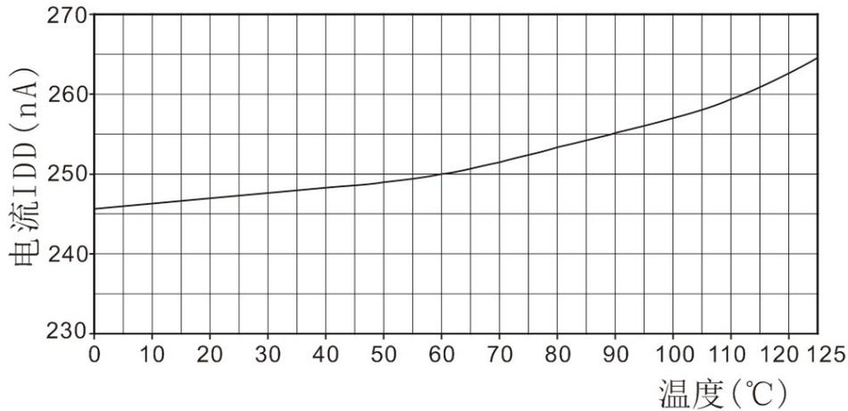
图6.VDD=3.3V时，典型的供电电流与温度的关系曲线（休眠模式）。请注意，这些数据与显示值存在大约±25%偏差。
