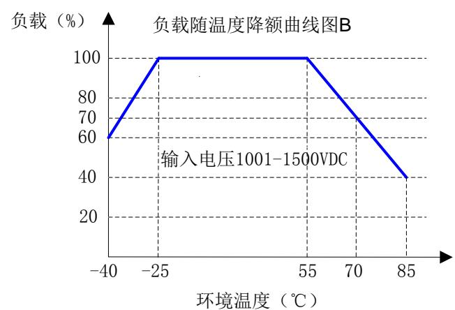
说明：需在输入电压降额基础上进行温度降额
