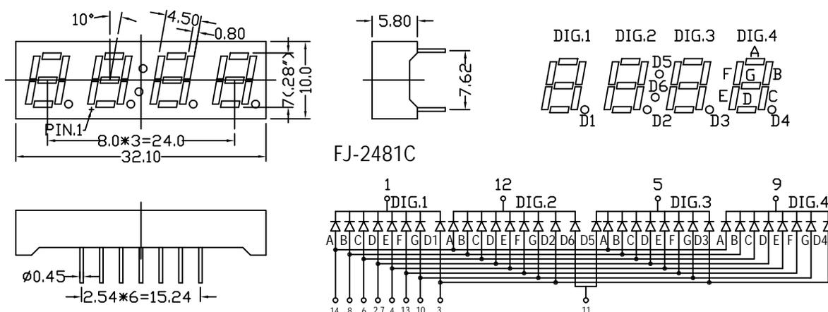
管脚顺序: 从数码管的正面观看, 以最左下边第一脚为起点, 管脚的顺序是逆时针方向排列
