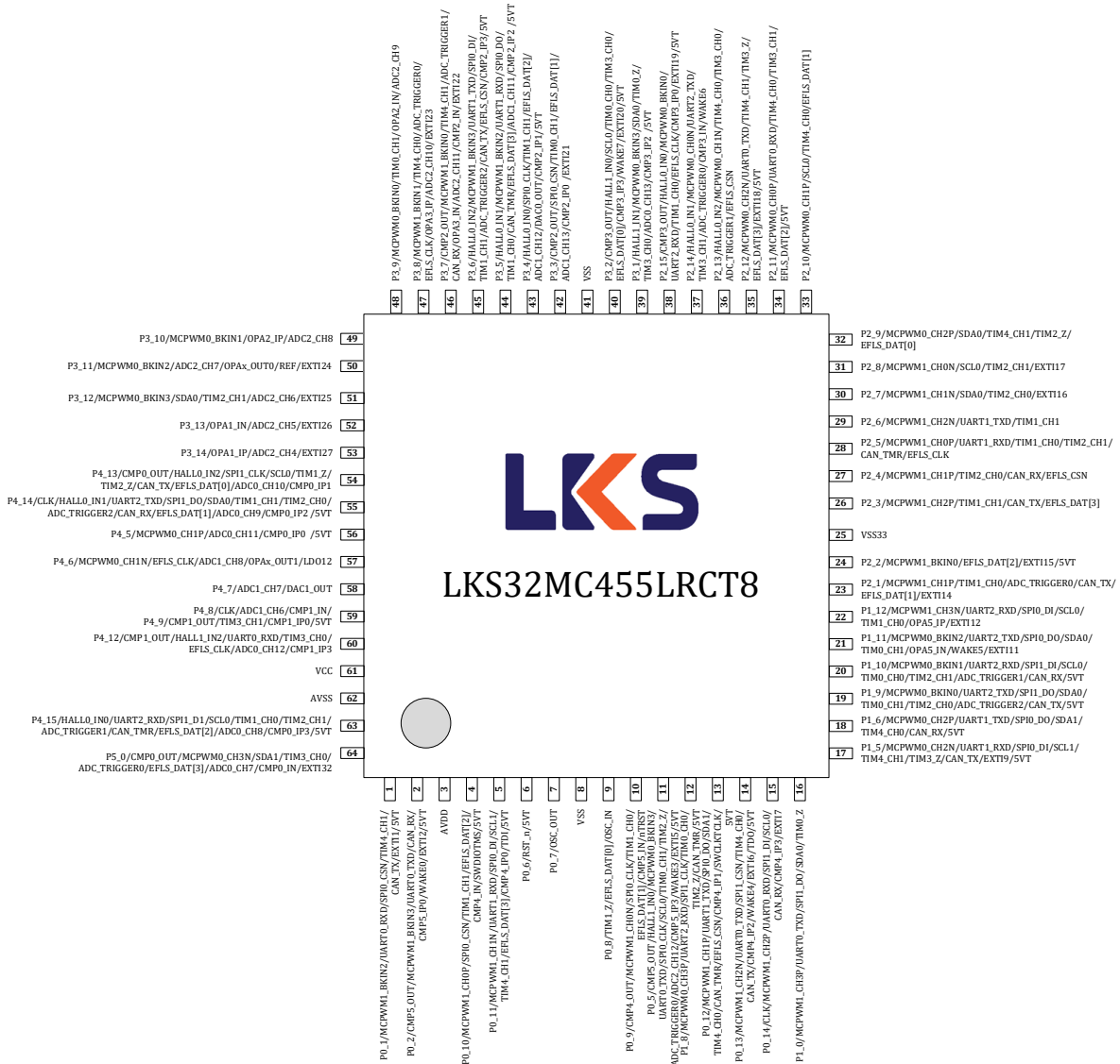
图 3-7 LKS32MC455LRCT8 管脚分布图
