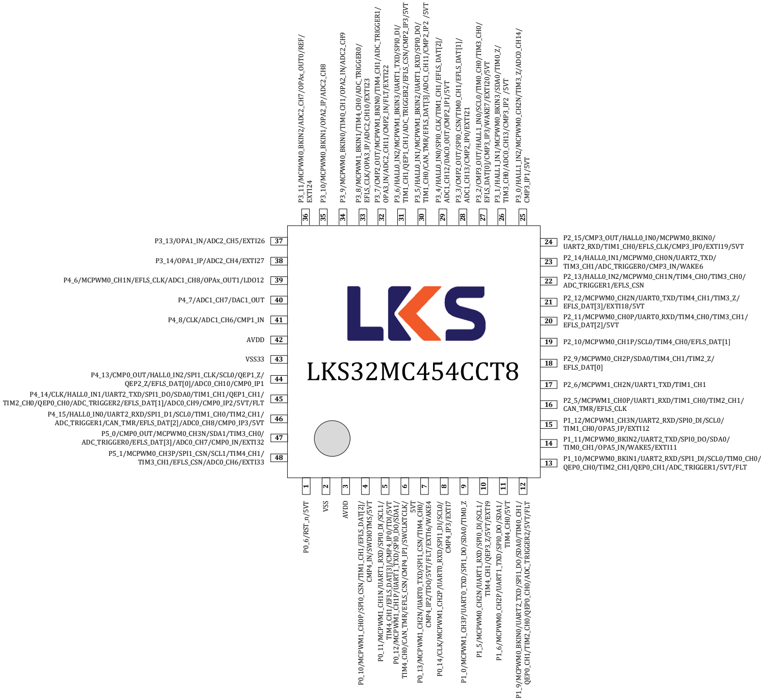
图 3-4 LKS32MC454CCT8 管脚分布图
