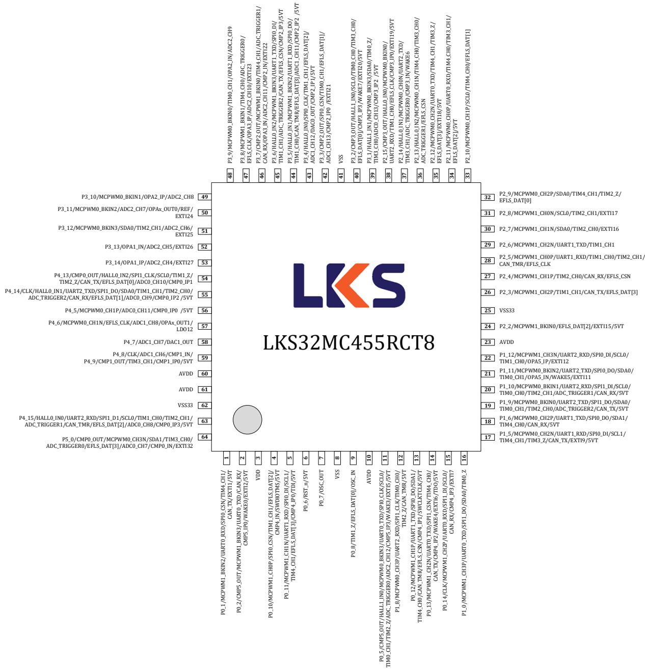
图 3-6 LKS32MC455RCT8 管脚分布图
