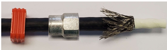
Figure / Abbildung 3.1.4.1: Cutting the foil / Abschneiden der Schirmfolie
