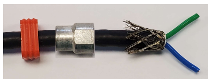
Figure / Abbildung 3.1.5.1: Separation of single wires / Vereinzelung der Einzelleiter
