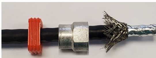
Figure / Abbildung 3.1.3.1: Preperation of the braid / Vorbereitung Schirmgeflecht
