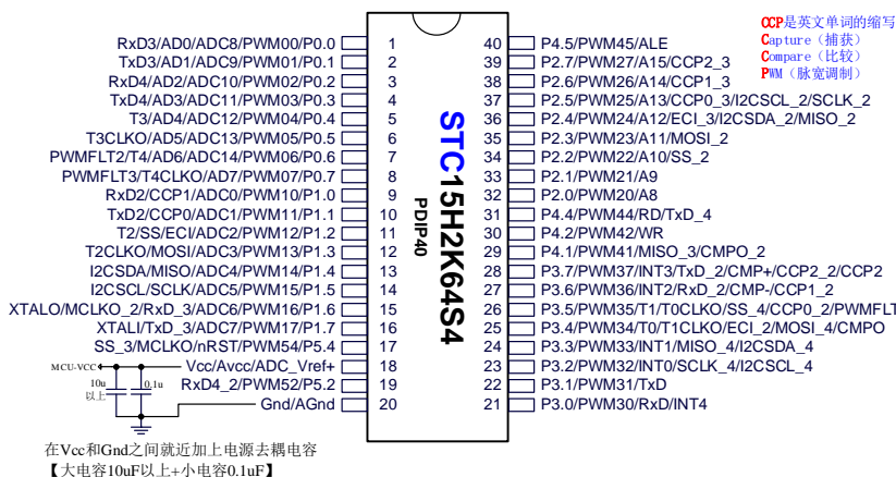
STC15H2K64S4-PDIP40 最小系统 示意图
