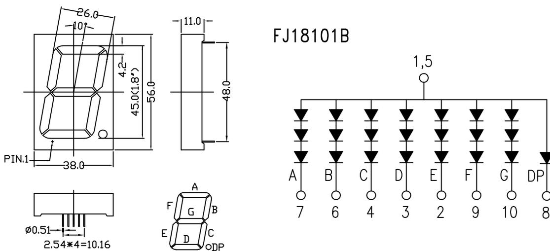
管脚顺序: 从数码管的正面观看, 以最左下边第一脚为起点, 管脚的顺序是逆时针方向排列
