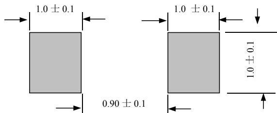
注：在此印锡面积条件下，推荐钢网厚度为 $\geq 0.12\text{MM}$ (钢网厚度不够要增大刷锡面积)
