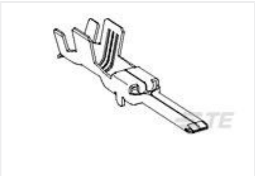
TE Part #1326029-3 2.8MM BLADE, UNSEAL,14-16AWG
