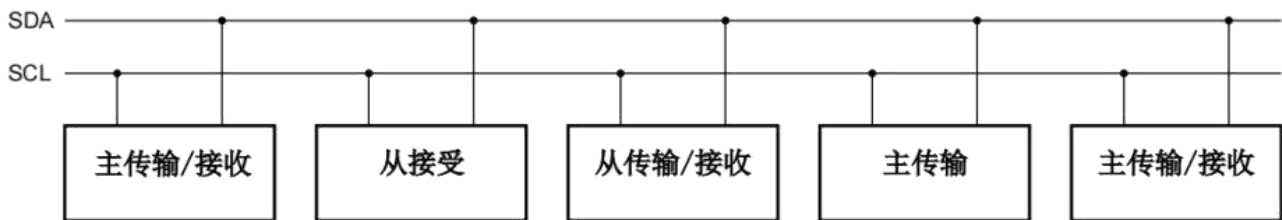
图 6 I 2 C 总线系统配置图
