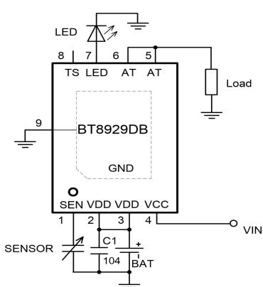
注：PCB LAYOUT 时 C1 尽量靠近芯片 VDD 脚；SENSOR 到 SEN 脚的线尽量细、短，并且尽量远离其它走线(特别是地线)；芯片 GND 脚附近尽量加大铺铜面积，以利于芯片散热。
