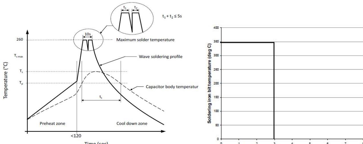
$T_s$ : 波峰焊接时电器本体最大受热温度
