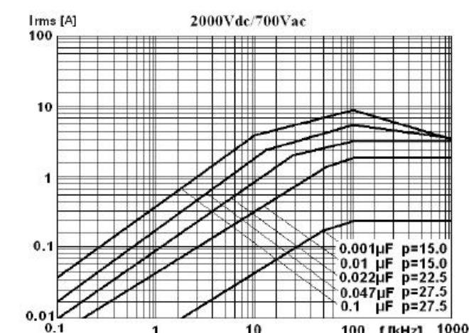
曲线图典型值在施压电压系正弦波形，环境温度≤85℃，电容器内部温升△T=10℃条件下试验。
