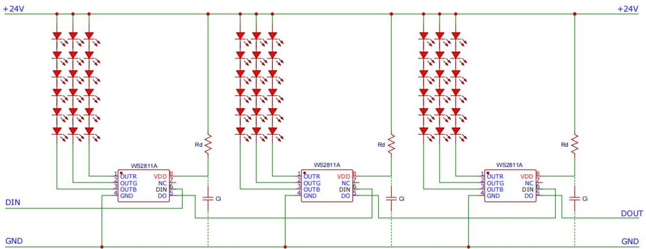
VDD脚可直接接到24V电源，不需要串电阻Rd和电容Ci也能正常工作，有助于国产高速贴片机的批量规模化生产。建议VDD串一颗电阻，用于防反接保护，同时建议并一颗电容，以提高抗干扰能力。
