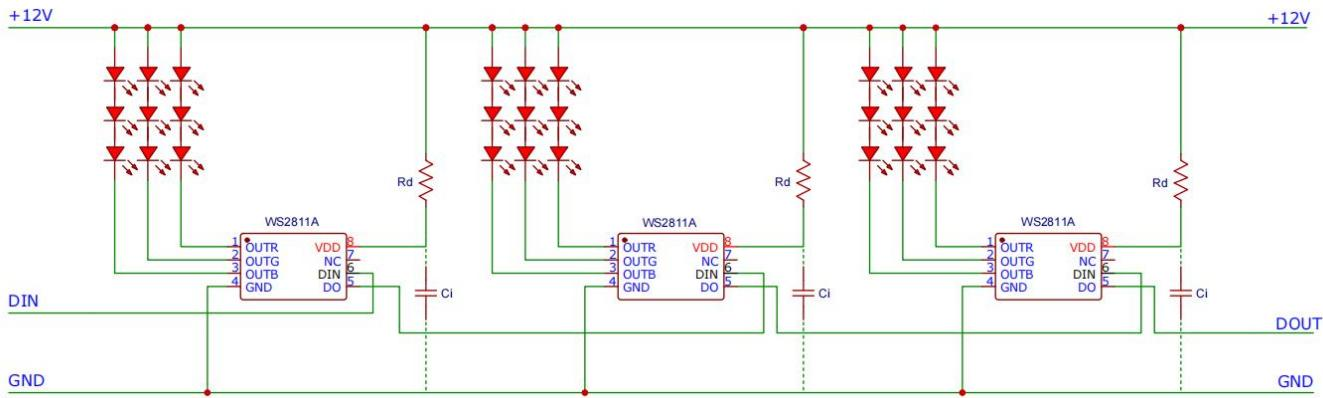
VDD脚可直接接到12V电源，不需要串电阻Rd和电容Ci也能正常工作，有助于国产高速贴片机的批量规模化生产。建议VDD串一颗电阻，用于防反接保护，同时建议并一颗电容，以提高抗干扰能力。
