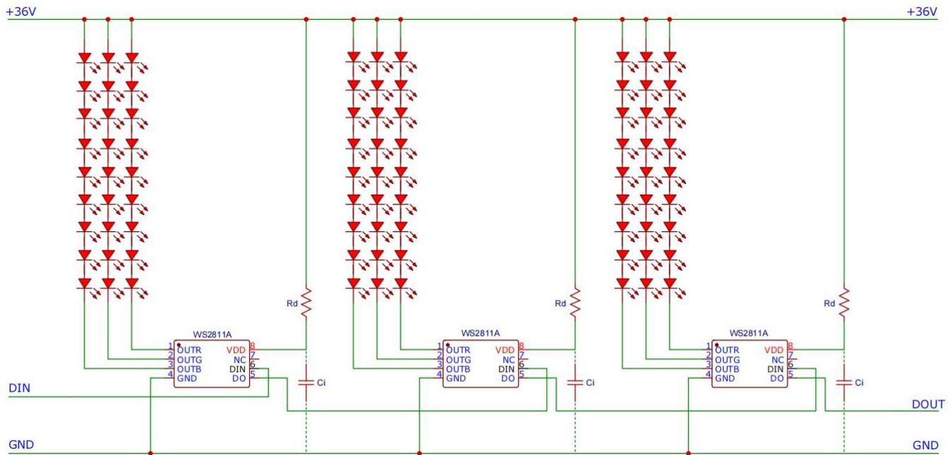
VDD脚可直接接到36V电源，不需要串电阻Rd和电容Ci也能正常工作，有助于国产高速贴片机的批量规模化生产。建议VDD串一颗电阻，用于防反接保护，同时建议并一颗电容，以提高抗干扰能力。
