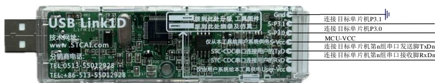
USB LinkID工具: 支持全自动停电-上电在线下载 / 脱机下载 / 仿真
