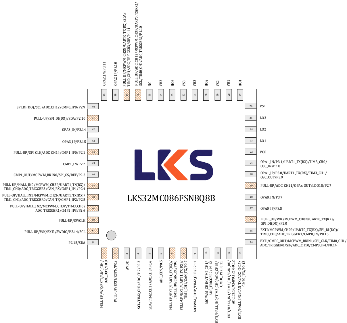
图 3-2 LKS32MC086FSN8Q8B 管脚分布图
