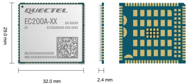
EC200A 系列是移远通信专为 M2M 和 IoT 领域设计的 LTE Cat 4 无线通信模块，采用 3GPP Rel-9 LTE 技术，支持最大下行速率 150 Mbps 和最大上行速率 50 Mbps。同时，EC200A 系列在封装上兼容移远通信的多网络制式 LTE Standard EC25 系列、EC21 系列、EC20-CE、EG25-G、EC200D 系列、EC200U 系列、EC200N-CN 和 UMTS/HSPA+ UC200A-GL 模块，实现了从 3G 网络向 4G 网络的轻松平滑过渡。
