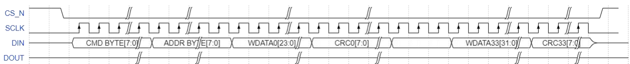
Figure 4-12 SPI 连续寄存器写帧时序 (包含 CRC 校验)
