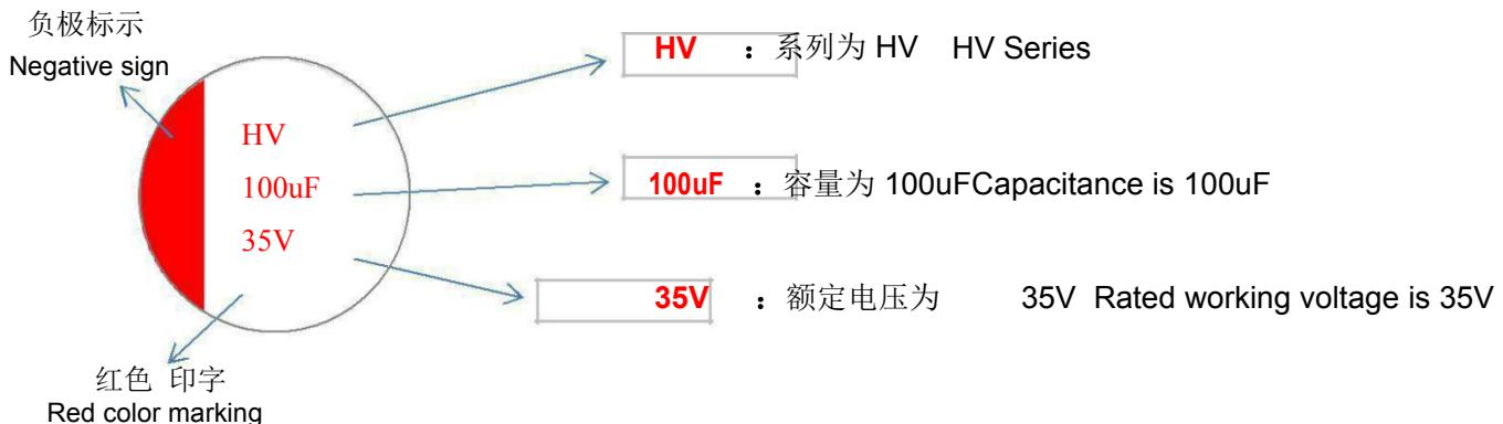
4> 产品结构图 Product Structure Diagram
