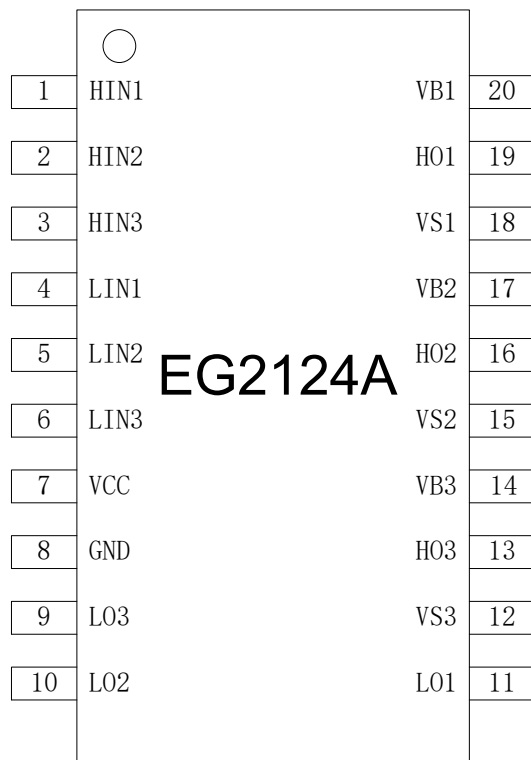
图 4-1. EG2124A 管脚定义
