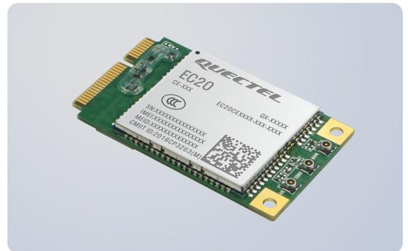
EC20-CE Mini PCIe 是一款支持 PCI Express Mini Card 标准接口的 LTE 模块。采用 LTE 3GPP Release 11 技术，支持最大下行速率 150 Mbps 和最大上行速率 50 Mbps；同时在封装上兼容移远通信多网络制式 LTE Cat 4 EG25-G Mini PCIe 模块，实现了从 3G 网络向 4G 网络的轻松平滑过渡。EC20-CE Mini PCIe 模块能够向后兼容现存的 EDGE 和 GSM/GPRS 网络，以确保在缺乏 3G 和 4G 网络的偏远地区也能正常工作。
