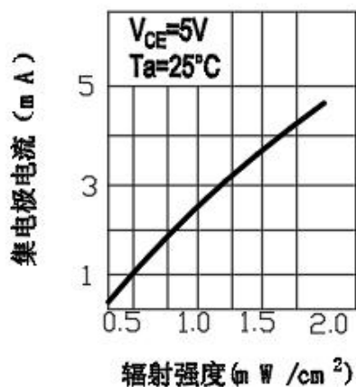
图五：集电极电流VS辐射照度
