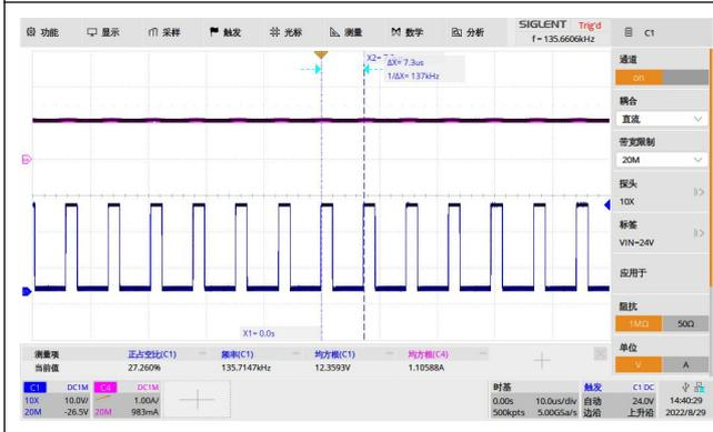
图6: 48Vin/12LEDs (CH1: V<sub>DRAIN</sub> CH4: I<sub>OUT</sub>)
