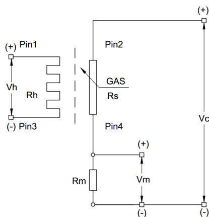
传感器基本检测电路主要由加热器电压 ( $V_h$ )、回路测量电压 ( $V_c$ ) 和负载匹配电阻 ( $R_m$ ) 组成。加热器电压 ( $V_h$ ) 用于激活和保持纳米材料的灵敏度，回路测量电压 ( $V_c$ ) 结合负载匹配电阻 ( $R_m$ ) 用于测定负载匹配电压 ( $V_m$ )。传感器敏感电阻 ( $R_s$ ) 可根据负载匹配电压 ( $V_m$ ) 的测定值进行计算，即：
