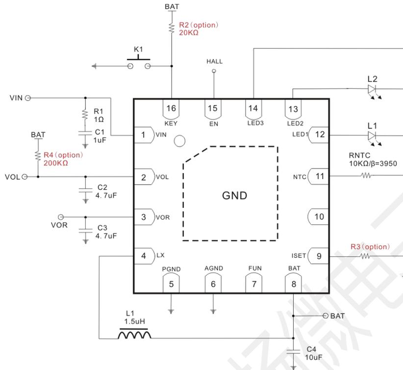
Fig6. 2 灯模式 (LED3 须接地)
