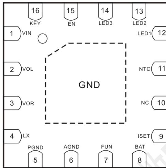
Fig3.管脚示意图
