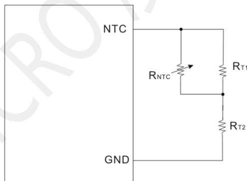
R<sub>NTC</sub> 采用阻值为 10K 且 $\beta=3950$  的 NTC 电阻，芯片通过检测 NTC 脚电阻值的大小来判断温度的高低，充电时高温检测电阻值为 4.4K，低温检测电阻值为 33K，充电时计算公式如下：
