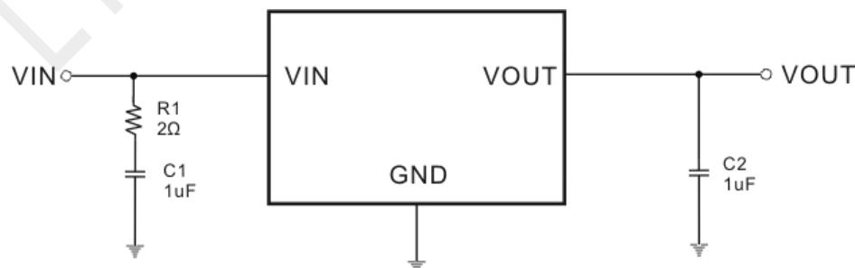
输入电容串 2 欧姆电阻，VIN 热插拔电压可到 28V 以上
