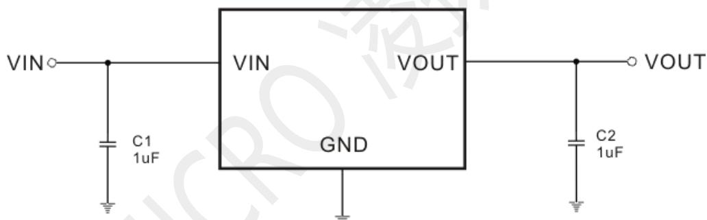
输入电容不串电阻，VIN 热插拔电压可到 15V
