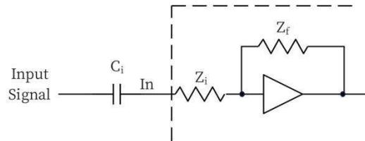
使用的输入电容器可用优质电解电容器、钽电容器或陶瓷电容器。若采用极性电容，正极应连接输入引脚。
