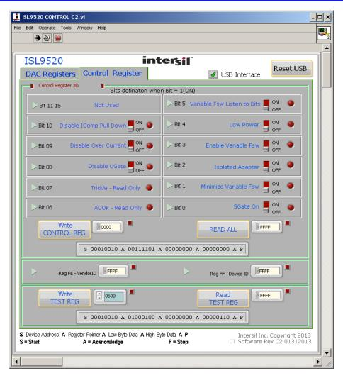
FIGURE 3. ISL9520 CONTROL REGISTER TAB
