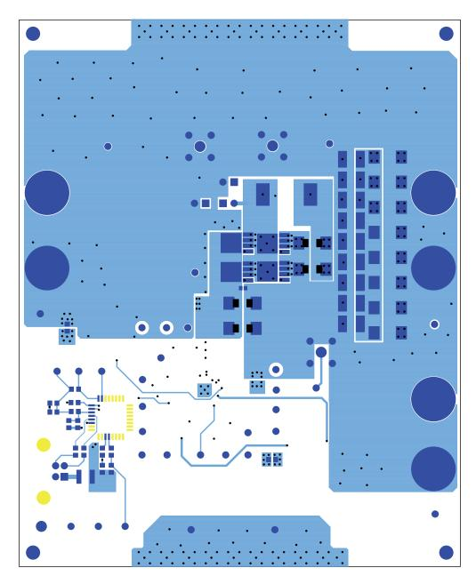
FIGURE 12. BOTTOM LAYER COPPER
