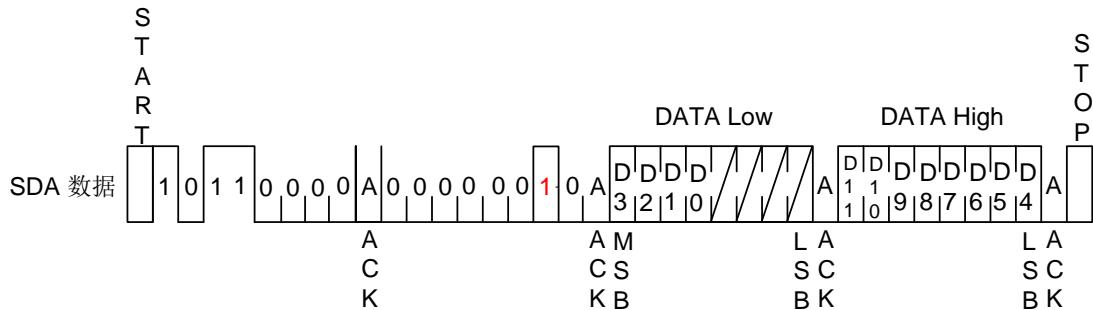
3.3.4 GP8202S 支持将电压数据保存在芯片内，保证掉电启动后依旧能处于相应的电压输出状态。
