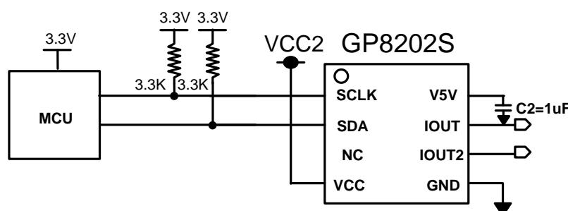
MCU输出3.3V的I<sub>2</sub>C接口需要接入上拉电阻后连接到GP8202S上。
