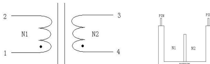
**绕线结构表 Winding Structure Diagram**
