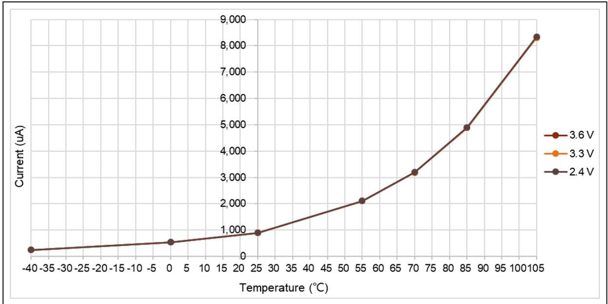
图 12. LDO 在额外低功耗模式时，深睡眠模式下的典型电流消耗在不同的  $V_{DD}$  时与温度的对比
