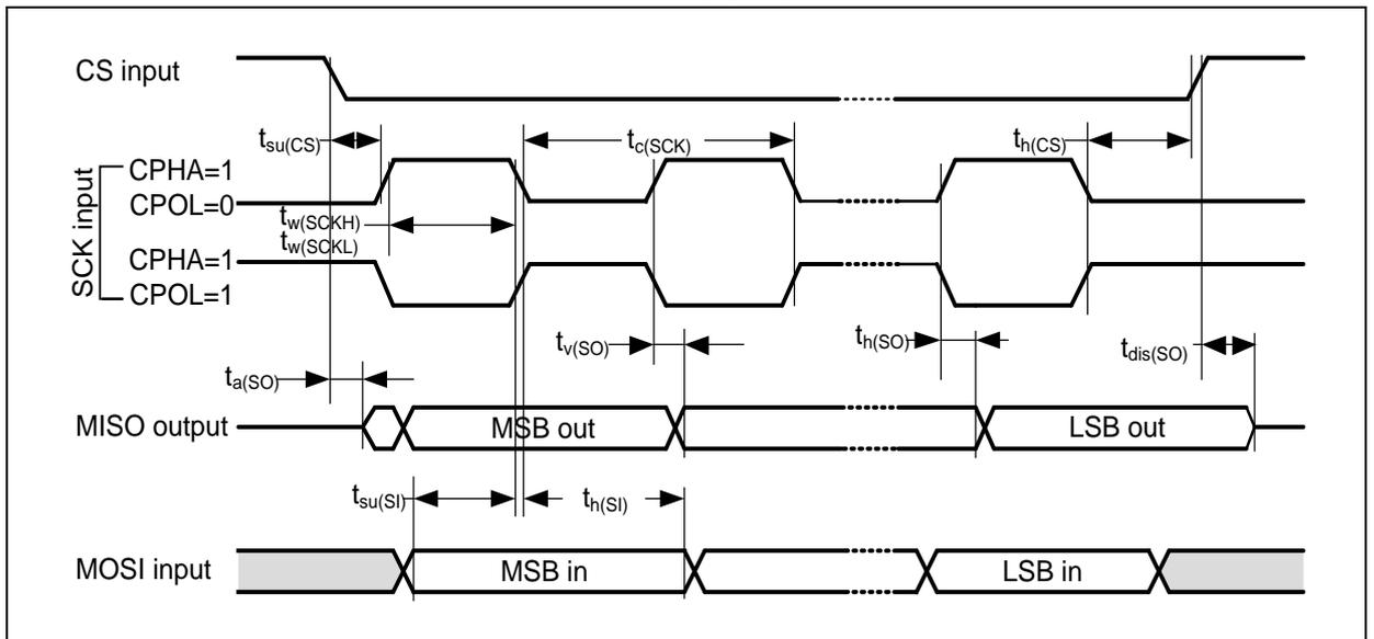
**图 22. SPI 时序图 - 主模式**
