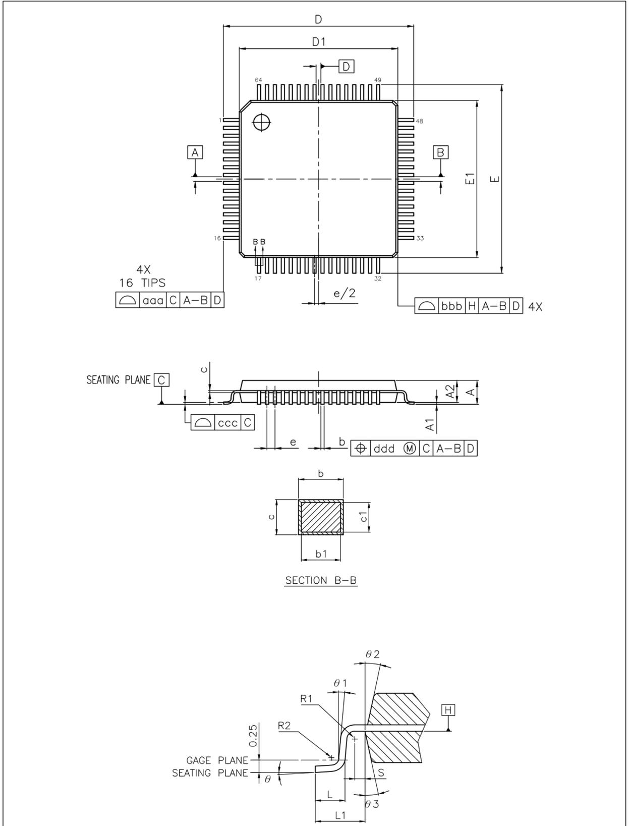
**表 55. LQFP64 – 10 x 10 mm 64 引脚薄型正方扁平封装机械数据**
