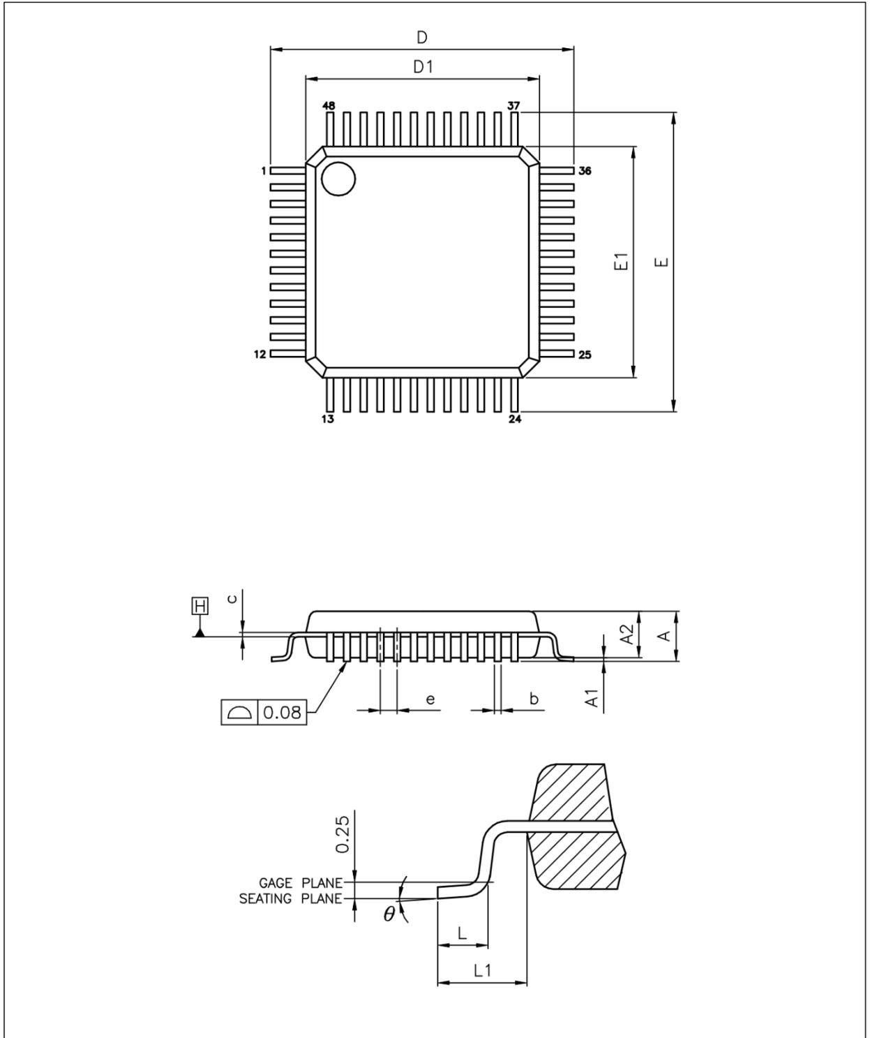
**表 57. LQFP48 – 7 x 7 mm 48 引脚薄型正方扁平封装机械数据**
