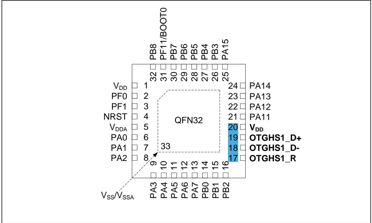
图 8. AT32F402 系列 QFN32 引脚分布
