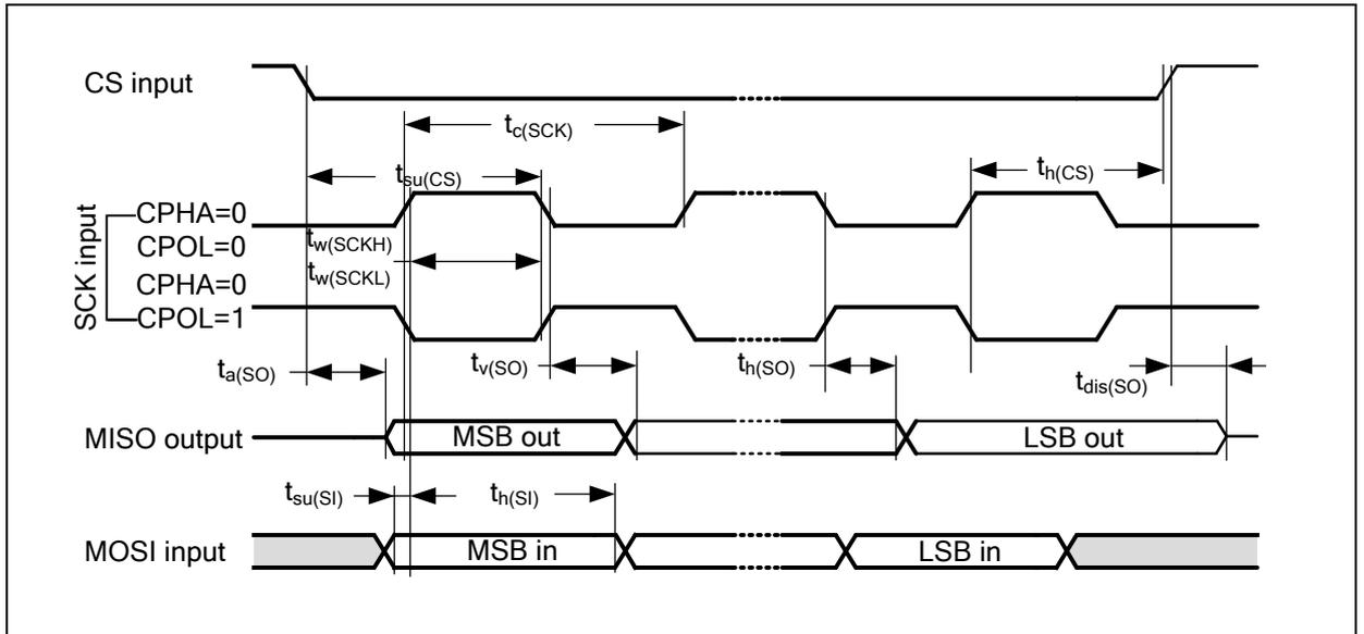
**图 21. SPI 时序图 - 从模式和 CPHA = 1**
