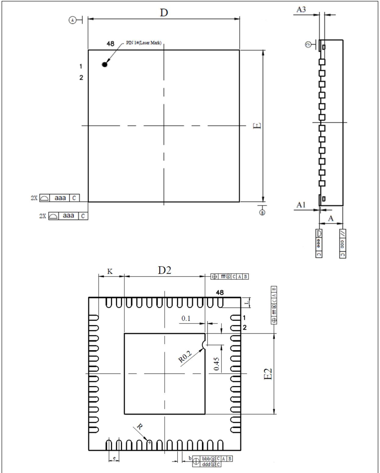
表 58. QFN48 – 6 x 6 mm 48 引脚正方扁平无引线封装机械数据
