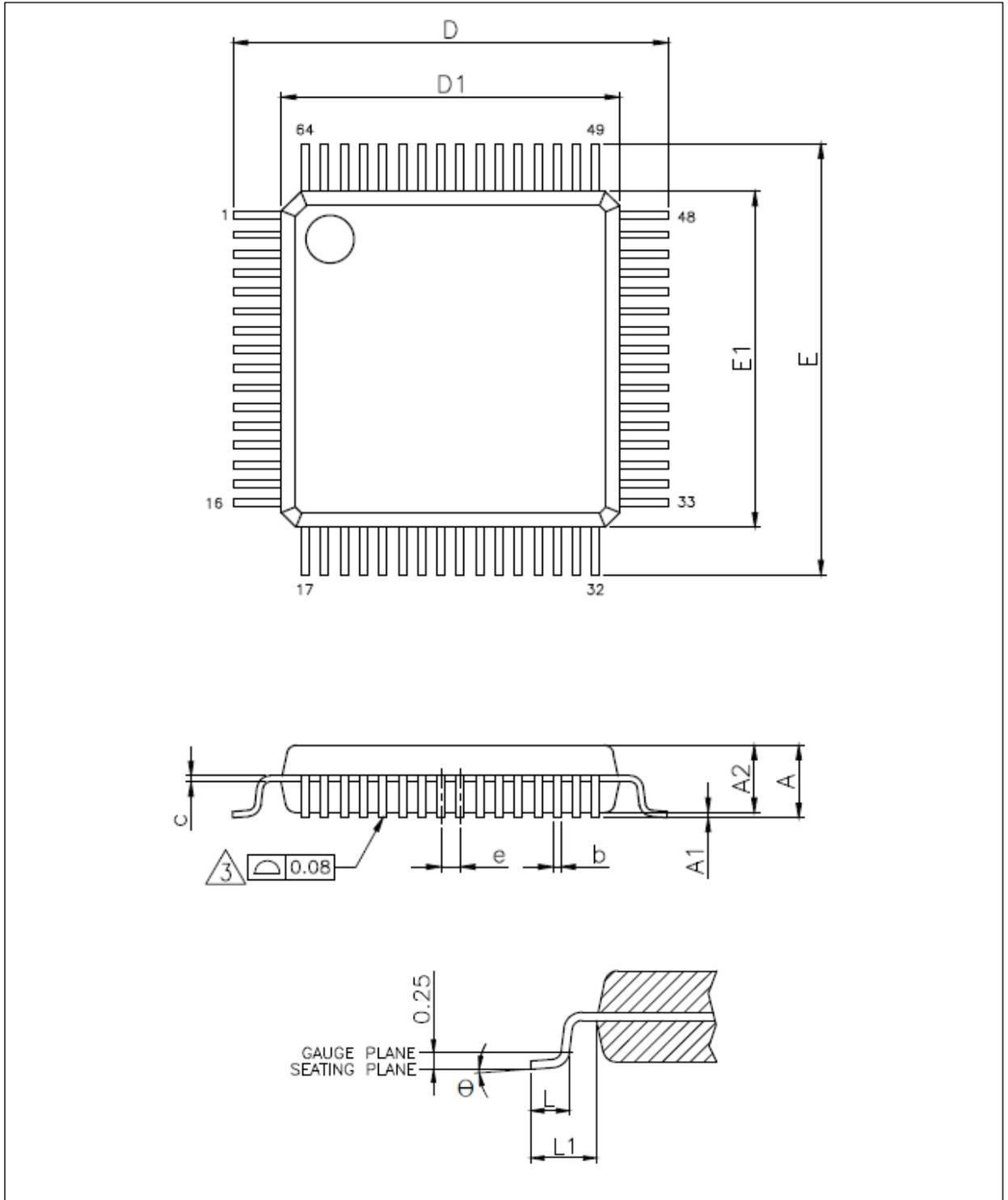
**表 56. LQFP64 – 7 x 7 mm 64 引脚薄型正方扁平封装机械数据**
