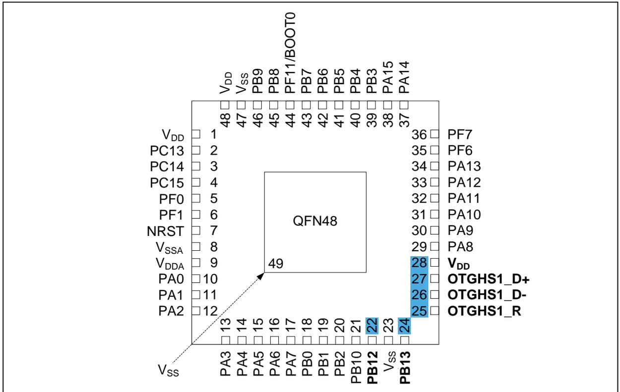
图 6. AT32F402 系列 QFN48 引脚分布
