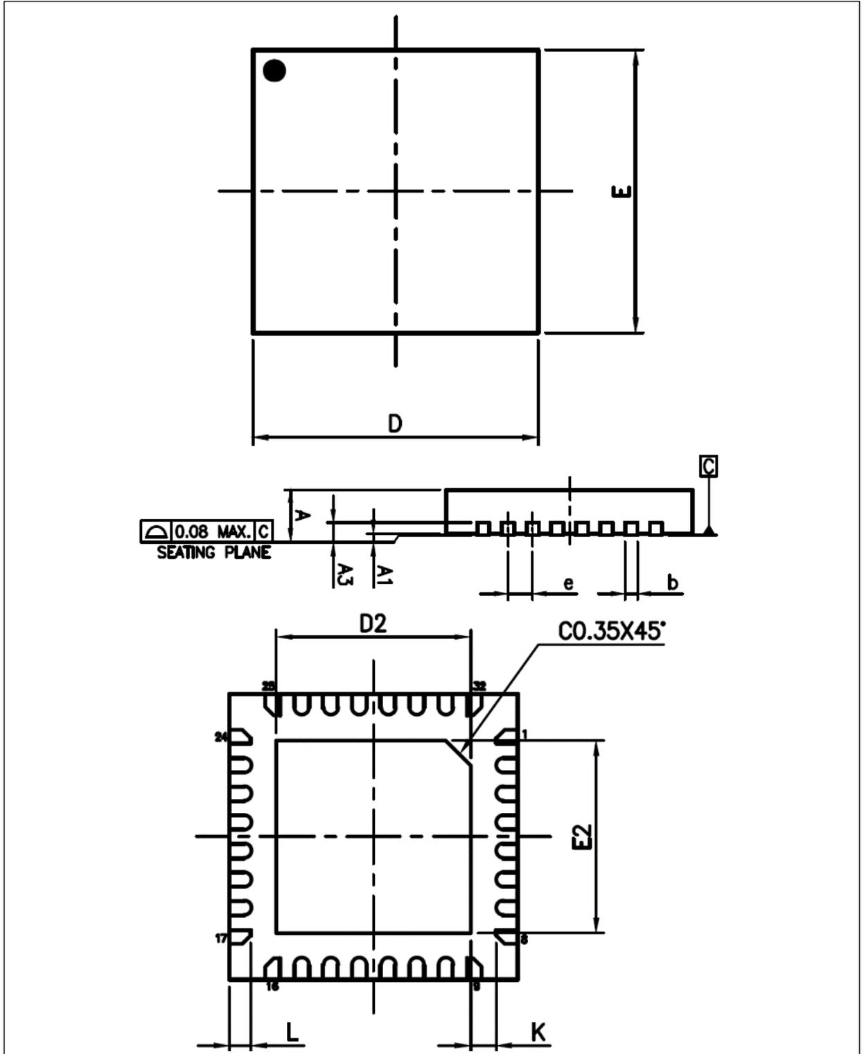
表 59. QFN32 – 4 x 4 mm 32 引脚正方扁平无引线封装机械数据
