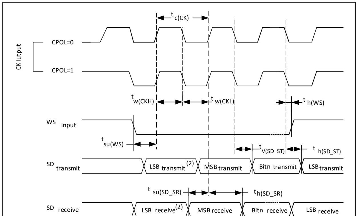
(1) 前一字节的最低位发送/接收。在第一个字节之前没有这个最低位的发送/接收。
