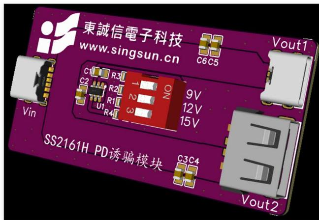
SS2161H PD 诱骗模块如上图，通过拨码开关可设置模块的输出电压，具体设置参考下表
