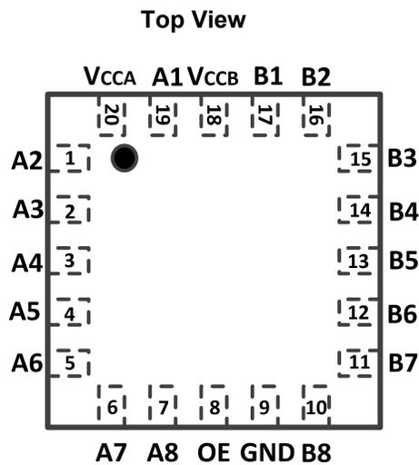
Fig.5-3. GT0108: QG (QFN3x3-20L) Package
