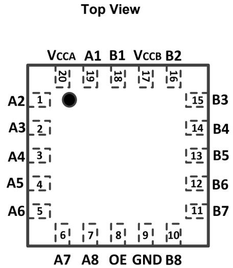
Fig.5-2. GT0108: BQG (QFN3x3-20L) Package
