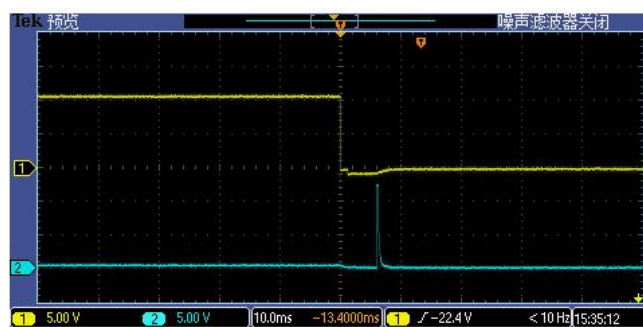
图 3 GM8023 继电器关断波形
