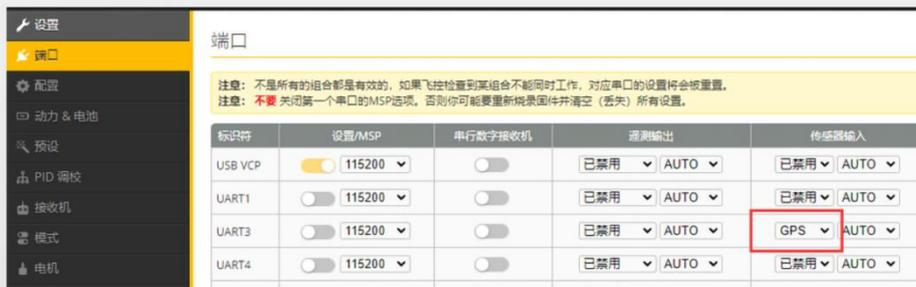
2.在配置页面启用GPS，并依下图所示依次打开对应功能：使用UBLOX协议、启用“自动波特率”、启用“自动设置”、启用“使用Galileo系统”
