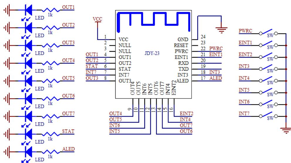
APP 可以控制 OUT1 到 OUT7 输出引脚的高低电平，APP 可以读取 EINT 与 INT 所有输入引脚的电平状态，其中 EINT1、EINT2 在模块连接状态支持主动上报电平状态
