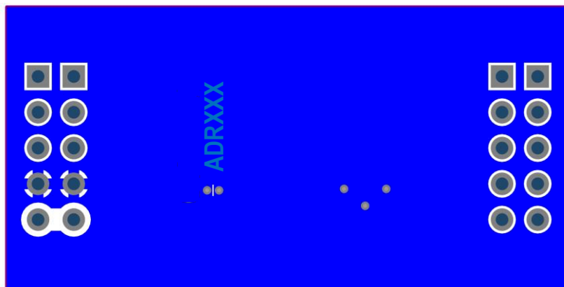
图27. ADRXXX 评估板 PCB 布局 (底层图)
