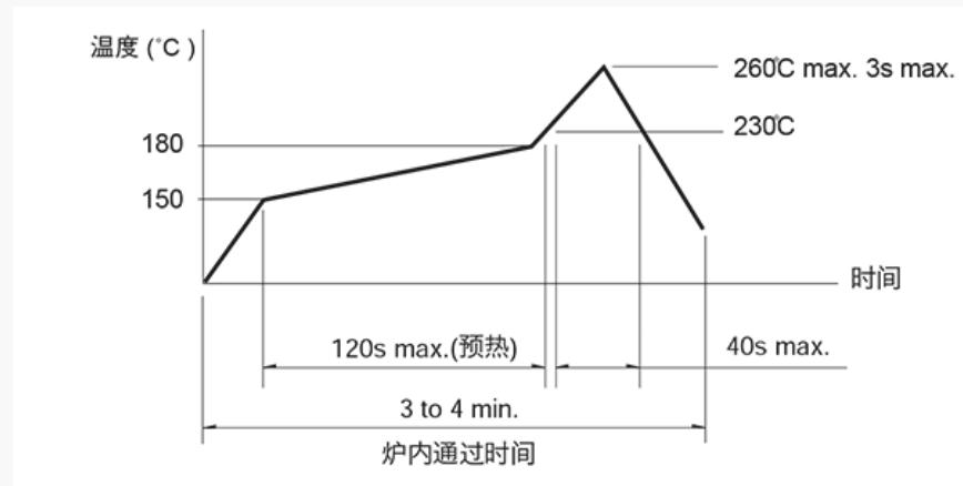
(1) 上述条件,为印刷电路板的零部品表面的温度。根据电路板的材质,大小,厚度等,电路板温度和开关表面温度会有很大的不同,关于开关表面温度,也请在上述条件下使用。
