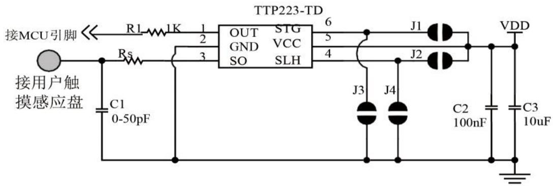
注 1: C1 电容值越大, 灵敏度越低, 感应面板的厚度就越薄。
