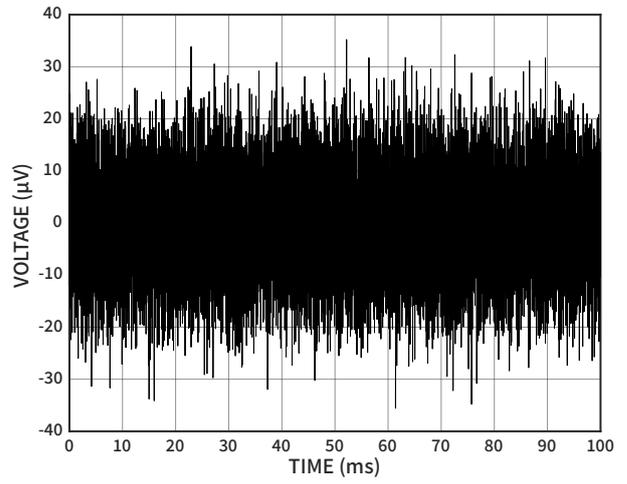
图 9 输出噪声 (10Hz~10kHz)
