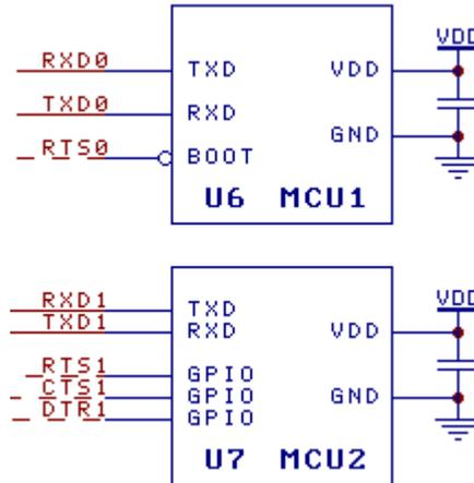
上图是双供电方式下两个 MCU 单片机分别通过两个 TTL 串口连接 CH342 芯片实现 USB 通讯的参考电路。CH342 由 USB 总线供电 VBUS，MCU1 和 MCU2 及 VIO 使用另一自供电电源 VDD，VDD 支持 5V、3.3V、2.5V、1.8V。
