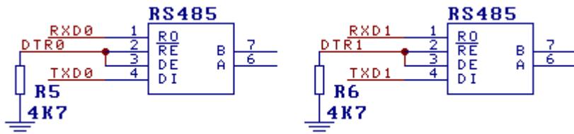
图中 DTR 引脚外接下拉电阻，从而切换为 T<sub>NOV</sub> 引脚，用于控制 RS485 收发器的 DE（高有效发送使能）和 RE#（低有效接收使能）引脚。RS485 收发器应该与 V10 使用同一供电电源。
