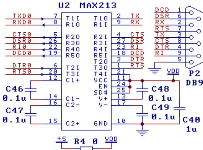
CH342F 提供了常用的串口信号及 MODEM 信号，图中通过外部电平转换电路 U2 将其中一路 TTL 串口转换为 RS232 串口，另一路类似，端口 P2 是 DB9 插针，其引脚及功能与计算机的普通 9 针串口相同，U2 的类似型号有 MAX213/ADM213/SP213/MAX211 等。图中 U2 通过 R4 由 USB 总线统一供电。
