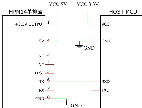
最简电路连接示意图
