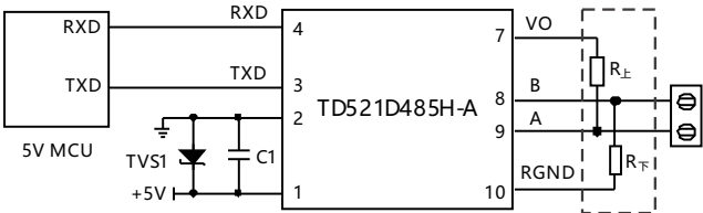
图1.MCU 5V供电应用电路
